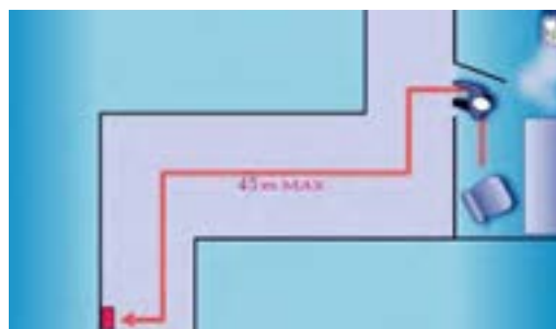
شکل ۲۱- فاصله دسترسی به شستی
