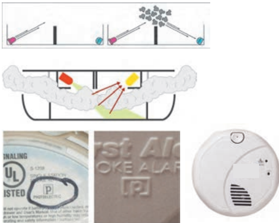
شکل ۳۲ - عملکرد دتکتور دودی و علامت مشخصه آن
